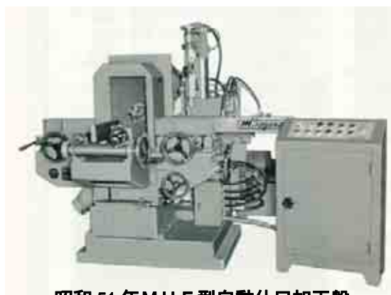
昭和 51 年 M H F 型自動仕口加工盤
