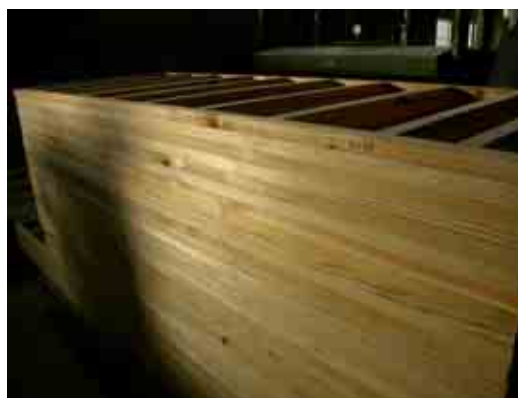
多摩スギを使った間仕切りパネルのコア （上の写真は積み重なっているところ）
