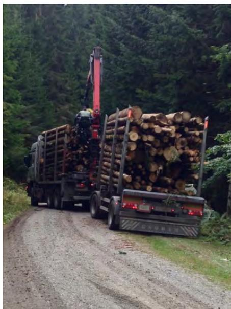
図 II-3-34 Gassen 市 フルトレーラ（林道端の 2 軸トレーラと接続を行っている様子）
