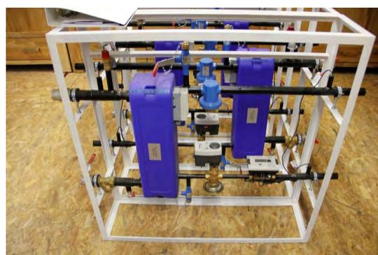
図 II-3-20 小型熱交換器
