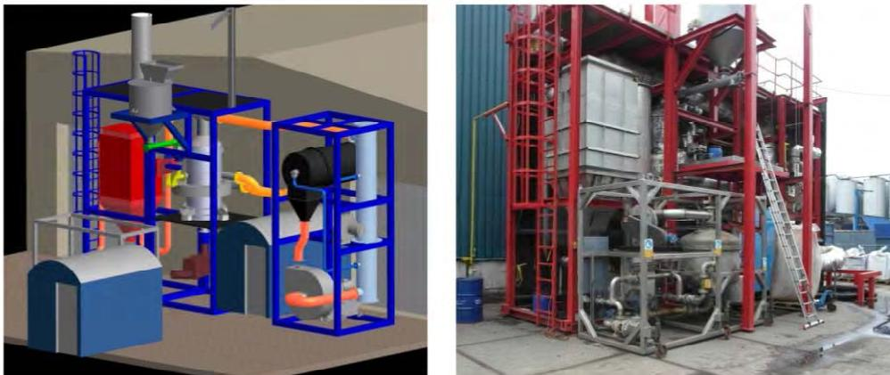
図 II -2-24 Synvastor© ガス化炉パイロット機<sup>13)</sup>
