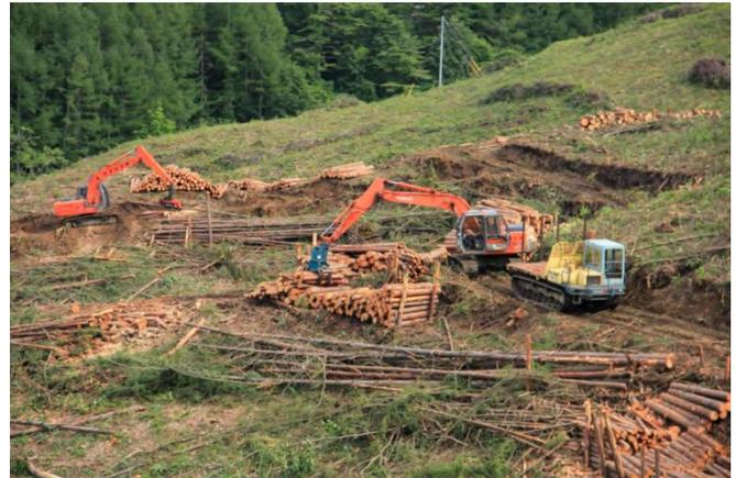
図Ⅲ-4-8 岩手県C社 プロセッサ造材とフォワーダ運材システム
