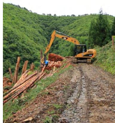
図Ⅲ-4-6 岩手県 A社 プロセッサ造材と仕分け作業
