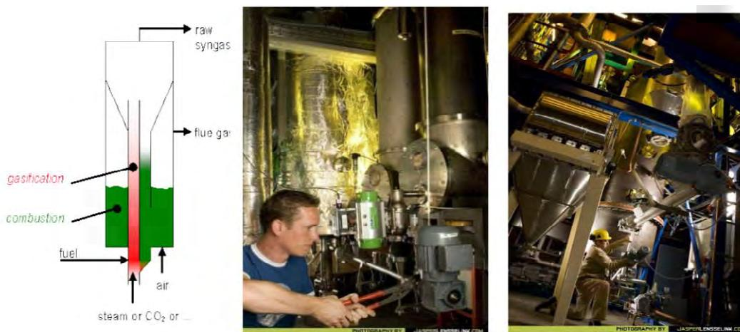
図 II -2-26 MILENA ガス化炉概念図（左）、25kW テスト設備（中央）、0.8kW テスト設備（右）<sup>13)</sup>
