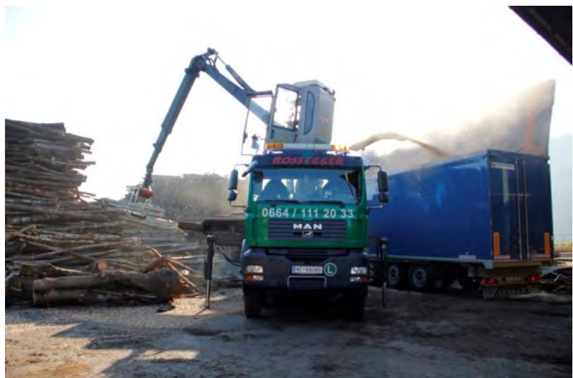
図Ⅱ-3-37 Leobenバイオマス流通センターにおけるチップ加工とスライドデッキコンテナトレーラ
