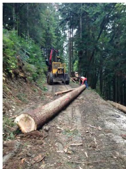
図Ⅱ-3-32 Gassen市 ウィンチトラクタによる全幹集材
