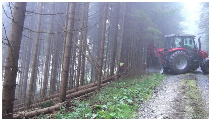
写真 15 トラクターのウィンチを利用したかかり木処理をしながらの全木集材
