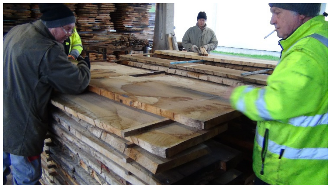
写真 10 天然乾燥のため積み重ねられる粗挽き板材
