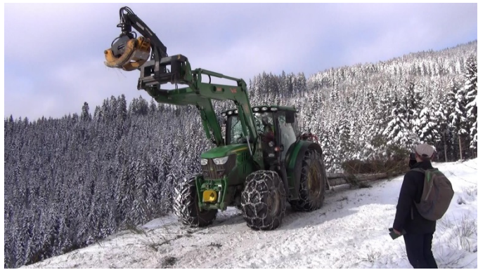
写真 17 グラップルを使って土場で極積みを行う
