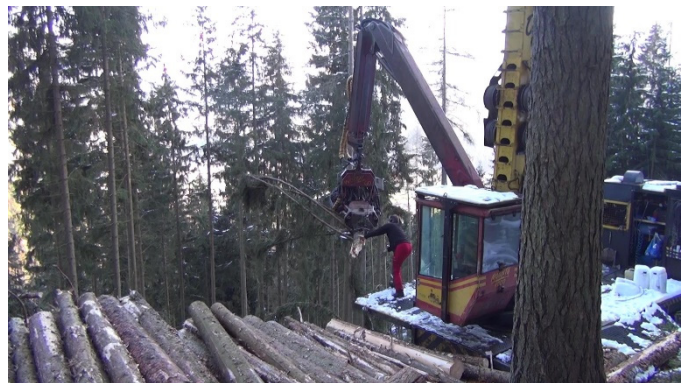
写真 12 折損木の搬出を行うタワーヤード
