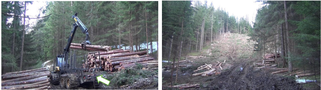
写真 14 フォワーダによる集材作業現場（左：ケーブル（矢印部分）アシスト機能を持ったフォワーダ、右：傾斜のある小面積皆伐現場の全景）
