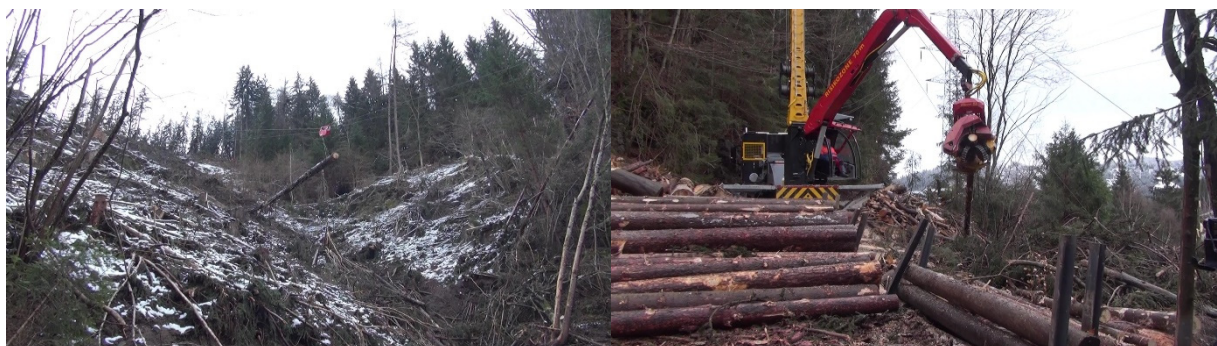
写真 11 急傾斜地におけるタワーヤーダによる架線集材（左：自走式搬器を用いた下げ荷集材の様子、右：林道を土場代わりに使うハイブリッドタワーヤーダ
