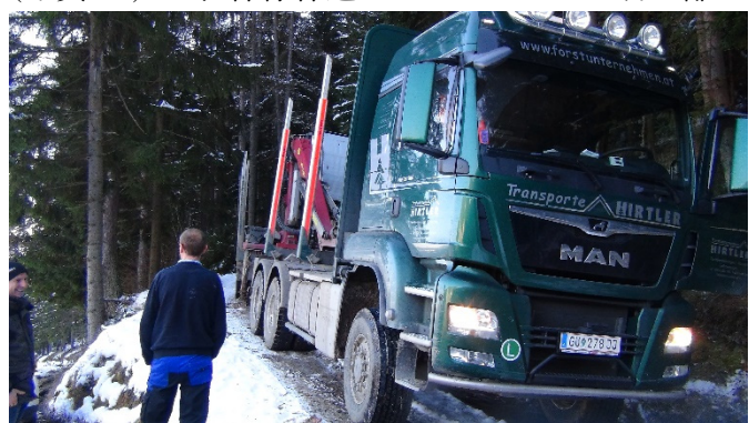
写真 13 林道上でトレーラーの切り離しを行ったフルトレーラー
