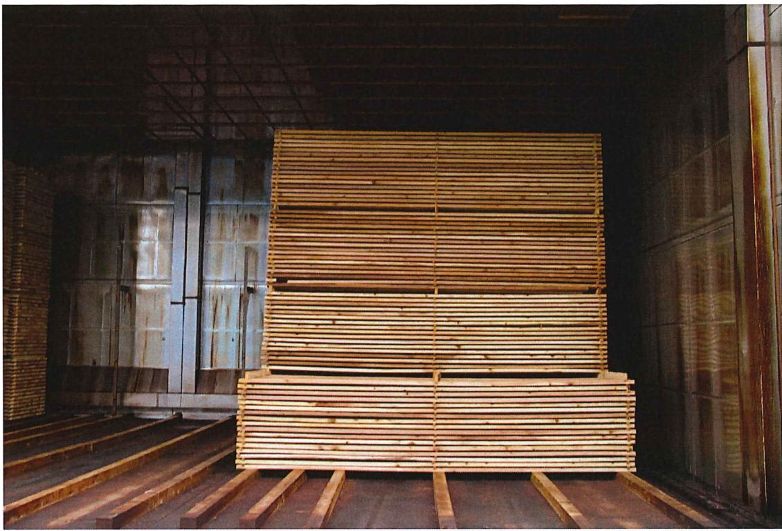
写真III・2 フェンス用原板の人工乾燥（棟の入れ方に注目）
