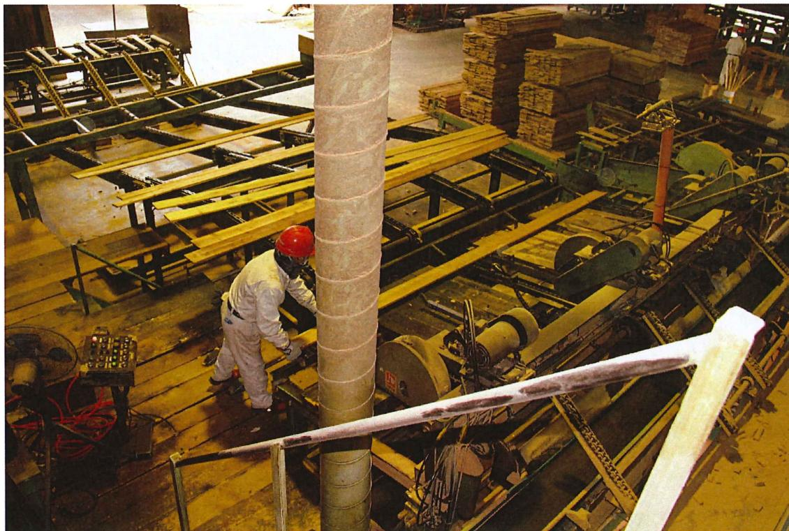
写真III・3 クロスカットソーで6フィートにカットする
