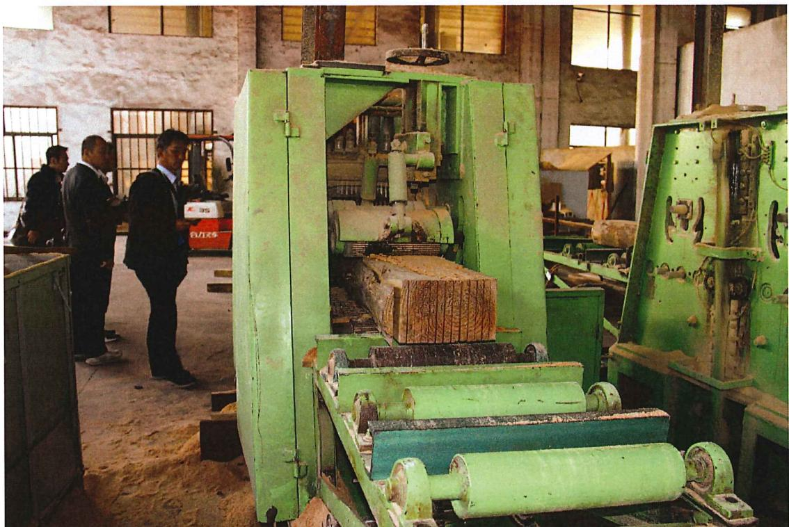
写真V・3 ギャングリッパーでフェンス材取り
