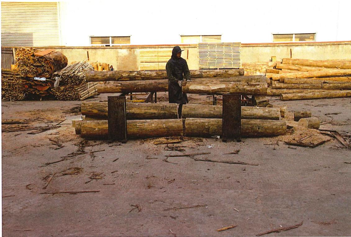
写真V・1 4mのスギ丸太を2mにカット
