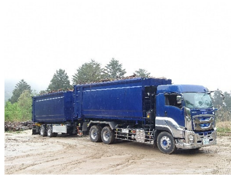
大容量を運搬できるフルトレーラーの導入により、チップ工場への運搬コストを低減
