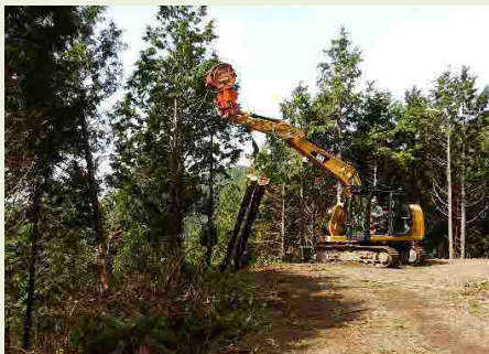
スイングヤーダによる集材（間伐）
