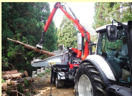
1オペレーターで切削チップ生産
