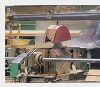
安全装置が破損
