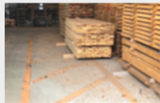
資材が範囲を超えて 置かれている (避難時の妨げになる 恐れ)
