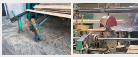
壊れた状態 応急処置のまま 安全装置が破損
