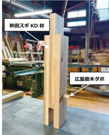
図-36 一面せん断試験体
