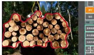
積層計算/材積確認（空隙率は任意設定）
